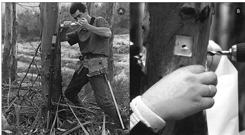
Figura 5 – O Pilodyn (A) e recolha de serrim para leitura em infravermelho próximo (B) permitiram a avaliação extensiva e a baixo custo de duas variáveis chave no melhoramento do eucalipto: a densidade e o rendimento em pasta.
