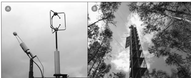
Figura 3 – Analisador infravermelho das concentrações de \text{CO}_2 e \text{H}_2\text{O} e anemómetro ultra-sónico (A). Este equipamento está instalado no topo de uma torre de 33 m, 13 m acima das copas dos eucaliptos (B).
