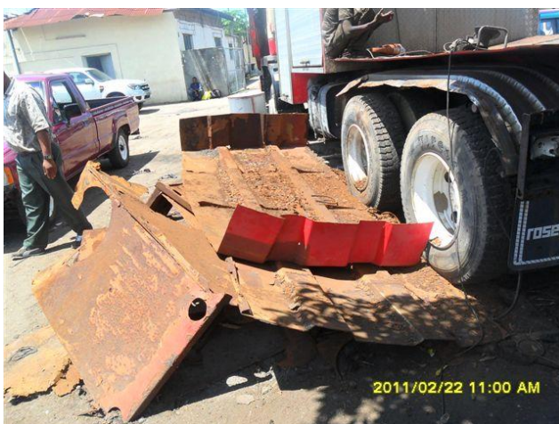
tanque de água completamente corroído
