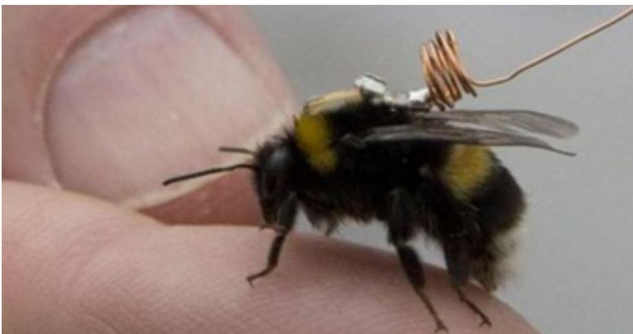
O rastreador é composto de um chip identificador por radiofrequência tradicional (RFID) e uma antena especialmente projectada, criada por O'Neill para ser mais fina e mais leve que outros modelos usados para rastrear pequenos insectos, o que permite o aumento do alcance. O engenheiro, que é director técnico da em-
